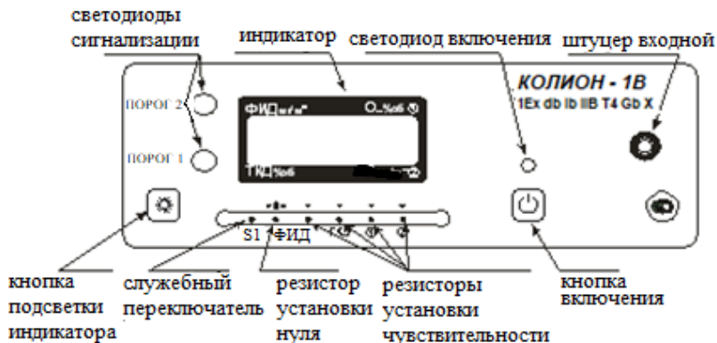
Рис. 1. Лицевая панель газоанализатора
